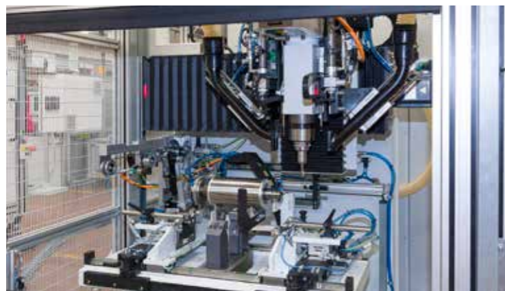
Equilibratrice per rotori di motori elettrici. Correzione automatica per fresatura radiale sui dischi di correzione. Lift pneumatico di carico/scarico. Balancing machine for electric motors. Automatic correction by radial drilling on the correction discs. Pneumatic loading/unloading lift.
