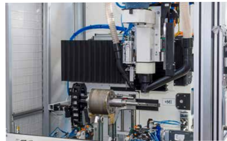
Equilibratrice con misura squilibrio su due piani con trascinamento a cinghia tangenziale e correzione per foratura radiale tramite unità verticale ad assi controllati. Balancing machine, measuring the unbalance on two planes, with tangential belt drive and equipped by a vertical drilling unit with controlled axes.
