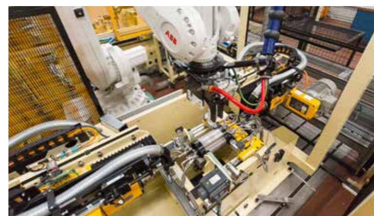
Impianto di equilibratura composto da cella robotizzata con due macchine equilibratrici, ognuna con funzione di misura e di correzione squilibrio. Il robot antropomorfo carica e scarica i pezzi dalla linea pallet del cliente sulle macchine equilibratrici e può anche caricare i rotori master da depositi interni. Balancing cell with robot and two independent balancing machines, each one with the full functionality of unbalance measuring and correction. The robot load and unload the part from a customer pallet line as well as any master rotor for the machine control from apposite storage location inside the cell.
