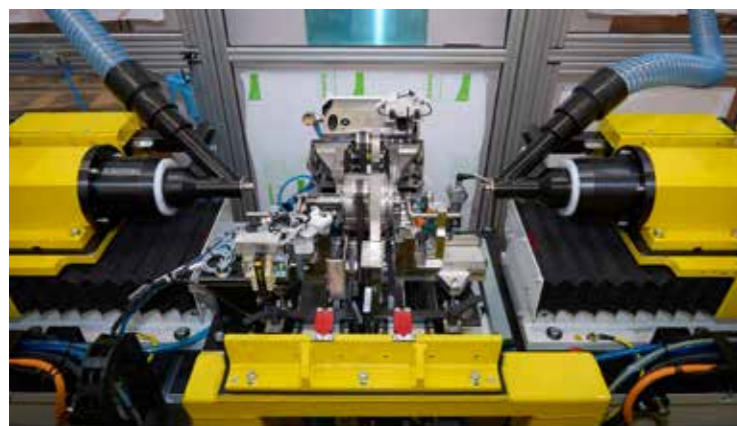
Equilibratrice per rotori di motori elettrici. Correzione automatica su due piani con trascinamento a cinghia e correzione per foratura assiale sui fianchi tramite due unità contrapposte ad assi controllati. Balancing machine for electric motors. Automatic correction on two planes with belt drive, and correction by axial drilling on the sides with two opposed units with controlled axes.
