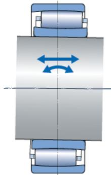
توزیع می شود . این بیرینگ ها جابجایی های در جهت محوری و ناهم راستایی زاویه ای را به طور همزمان، تا حد قابل قبولی می توانند تحمل نمایند. این بیرینگ صنعتی همچنین می تواند سطح مقطع کمی مثل رولبرینگ های سوزنی داشته باشد. روش این انتقال بار در شکل زیر مشخص می باشد. ظرفیت حمل بار **انواع بیرینگ صنعتی CARB** حتی در شرایطی که جابجا شده و در رینگ خود نیستند و یا تحت نا هم راستایی هستند، بسیار مناسب می باشد.
