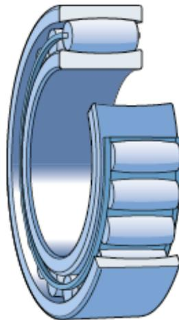
رولبرینگ های **CARB** خود راهنما ( self-Guiding ) هستند این ویژگی بسیار کاربردی می باشد و در هر شرایط کاری و در صورت جابه جایی یا کج شدن رینگ داخلی نسبت به رینگ خارجی، خود را تنظیم کرده و با به صورت یکنواخت و مساوی در طول رولبرینگ
